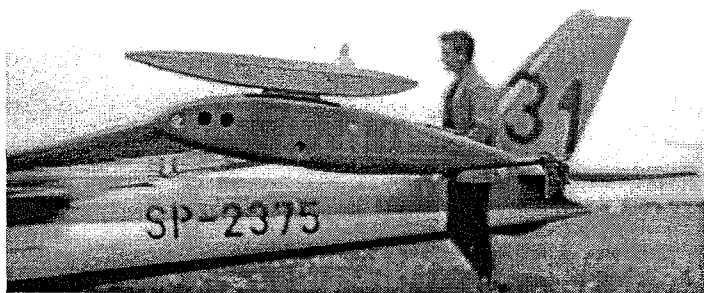
Anteny „termoszuków” konstrukcji Zbigniewa Kirakowskiego, mierzące temperatury na końcach skrzydła i usterzeniu, a na tej podstawie wskazujące kierunek noszenia (prawdopodobnie)
